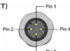
PLEASE USE ONLY SHIELDED SUPPLY CABLES AND SET THE SCREEN ON ONE SIDE (TO AVOID GROUND LOOPS)!
